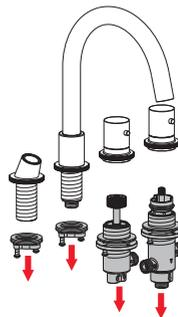
Извлеките гайки с фиксирующими винтами, металлические и резиновые шайбы из держателя для ручного душа и комплекта для излива.
