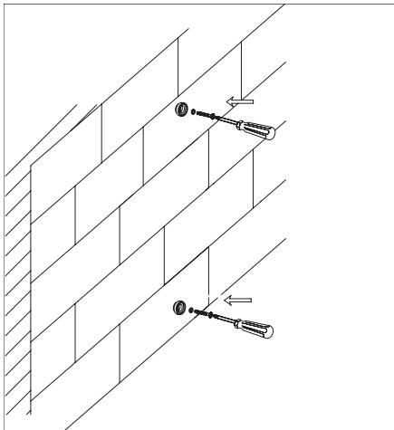
2. Вставьте винты в кольцевые фиксаторы и прикрепите их к пластиковым дюбелям на стене с помощью отвертки
