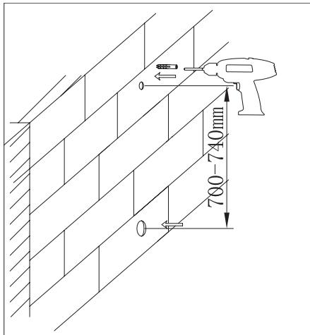
1. Отметьте места для отверстий на стене в соответствии с чертежом. Просверлите отверстия в стене в соответствии с диаметром прилагаемого набора дюбелей. Вставьте пластиковые дюбели в отверстия
