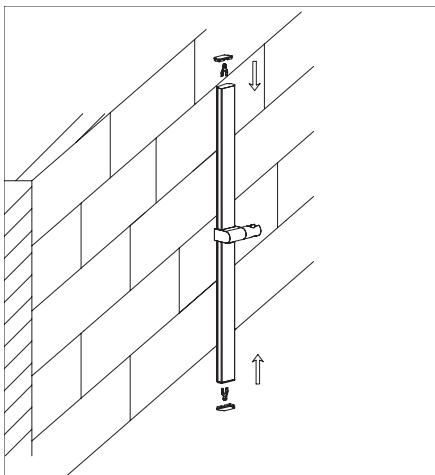
4. Закрепите пластиковый зажим на кольцевых фиксаторах внутри стойки. Установите декоративные крышки обратно на стойку.
