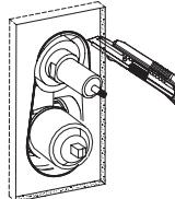
Закройте отведенное место плиткой, в которой предварительно должны быть вырезаны 2 отверстия по размеру купола или размеру герметичного короба
