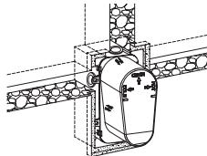
Подключите горячее (слева) и холодное (справа) водоснабжение, используя соответствующие методы уплотнения. Снимите крышку герметичной коробки и проверьте надежность подачи воды при открытом и закрытом положении смесителя.
