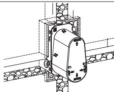
Подключите горячее (слева) и холодное (справа) водоснабжение, используя соответствующие методы уплотнения. Снимите крышку герметичной коробки и проверьте надежность подачи воды при открытом и закрытом положении смесителя.
