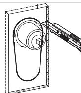
Закройте отведенное место плиткой, в которой предварительно должны быть вырезано отверстие по размеру купола или размеру герметичного короба.
