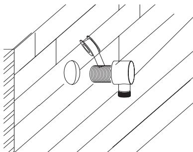
**2.2 Установка корпуса смесителя.** Соберите корпус с эксцентриками, закрепив гайки гаечным ключом. Убедитесь, что резиновые уплотнительные прокладки находятся внутри гаек.
