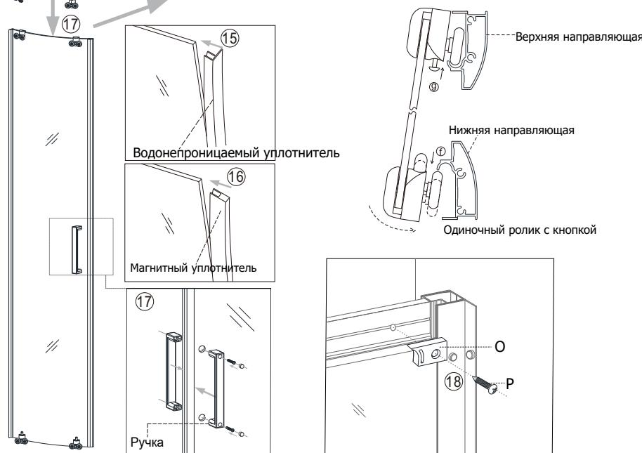
4.1) Закрепите ролики на раздвижной стеклянной двери, отрегулируйте дверь и наденьте на ролики крышку. Установите водонепроницаемый уплотнитель и магнитный уплотнитель.
