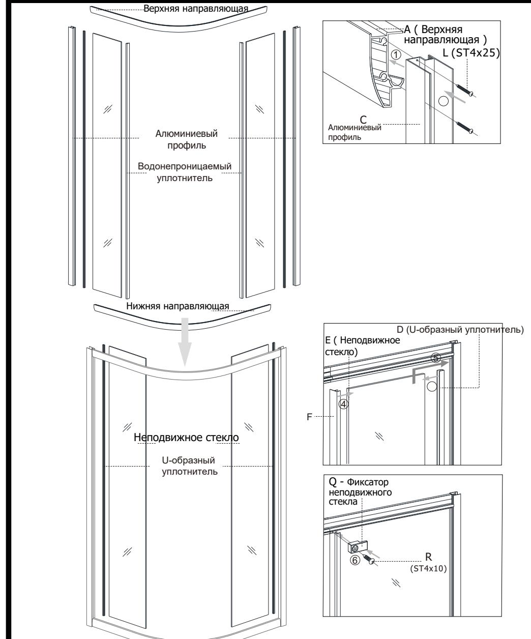
2.1) Скрепите алюминиевый профиль и верхнюю направляющую винтом K(ST4\*25). Установите U-образный уплотнитель на неподвижное стекло и вставьте в алюминиевый профиль, закрепите на неподвижном стекле фиксатором неподвижного стекла и винтом R (ST4\*10)
