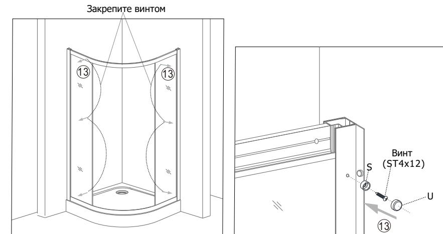
3.2) Наконец, соедините профиль регулировки и алюминиевую раму с винтом (ST4x12) и пластиковую прокладку (s), а затем закрепите декоративный колпачок на винт.
